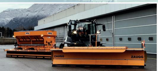
Visibilité et maniabilité s'avèrent également précieuses pour les travaux hivernaux. La puissance des interventions de fraisage correspond à celle d'une fraiseuse automotrice grâce à la transmission hydrostatique-mécanique.
