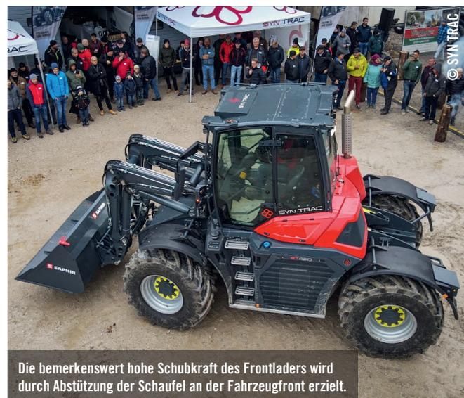
Die bemerkenswert hohe Schubkraft des Frontladers wird durch Abstützung der Schaufel an der Fahrzeugfront erzielt.
