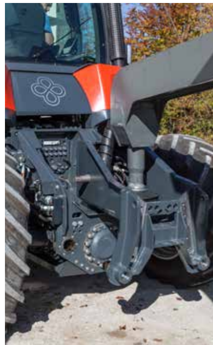
Das Kuppeln des Adapters inklusive aller Anschlüsse erfolgt automatisch.
