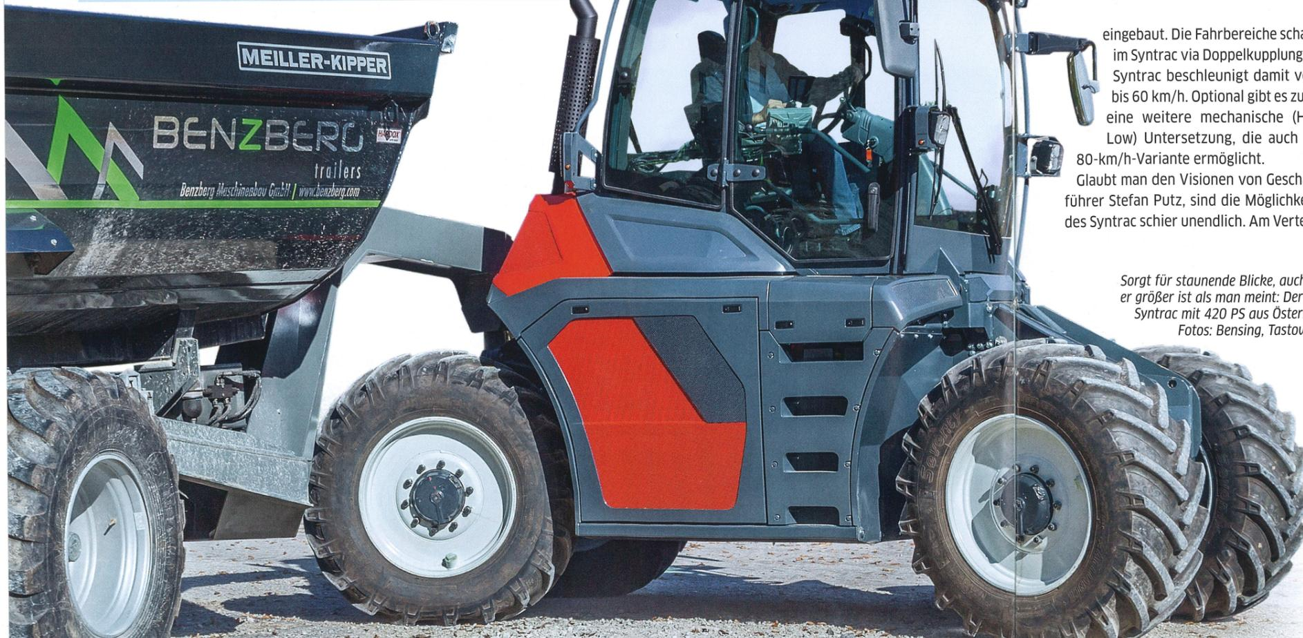
eingebaut. Die Fahrbereiche schalten im Syntrac via Doppelkupplung. Der Syntrac beschleunigt damit von 0 bis 60 km/h. Optional gibt es zudem eine weitere mechanische (High/Low) Untersetzung, die auch eine 80-km/h-Variante ermöglicht.
