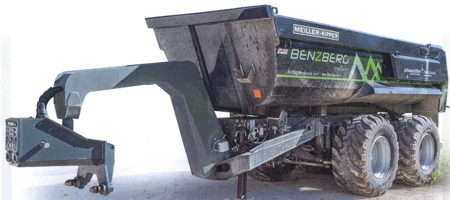
Für jedes Anbaugerät muss ein Adapter für den Syntrac angefertigt werden. Dann ist der automatische Wechsel leicht möglich. Für Anhänger setzt Syntrac auf einen Schwanenhals.
