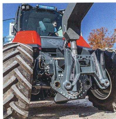
Durch Absenken der hydraulischen Federung fährt man unter das zu koppelnde Gerät und zieht den Rahmen mit den hydraulischen Haken direkt in den Koppelrahmen – fertig.
