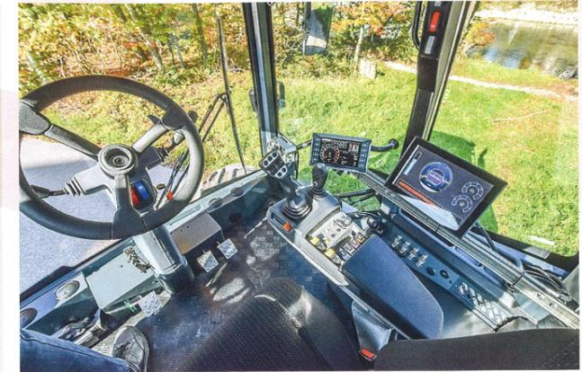
In der großräumigen Kabine haben zwei Personen Platz. Die Sicht nach vorne und hinten ist super. Die Bedienkonsole besteht aus dem Joystick samt Armlehne. Das Display zeigt Basisdaten zum Fahrzeug. Für Anbaugeräte werden zusätzliche Displays in der Kabine montiert.
