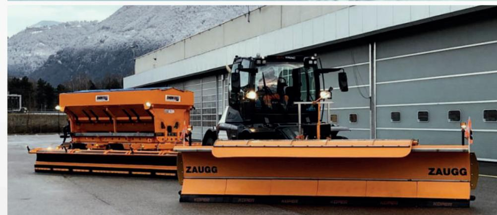
Übersicht und Wendigkeit machen sich auch im Winterdienst bezahlt. Der Leistungsumfang bei Fräseinsätzen entspricht durch das hydrostatisch-mechanische Getriebe dem einer selbstfahrenden Fräse.
