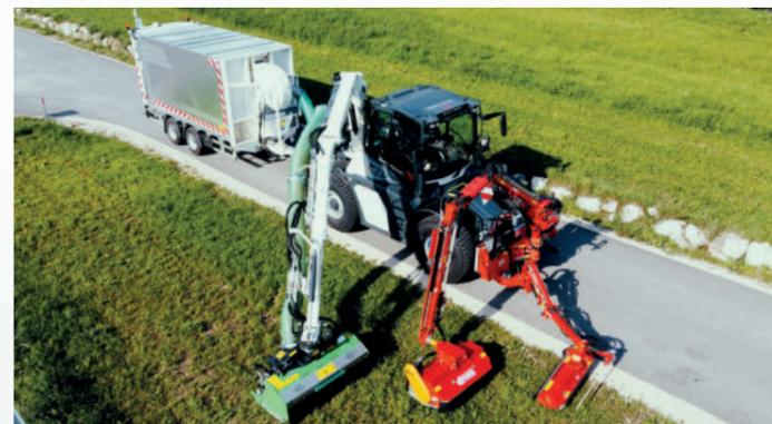
Statt drei Spezialfahrzeugen ein SYN TRAC-Gespänn: Die komfortable Ein-Mann-Bedienung beider Anbaugeräte ermöglicht den gleichzeitigen Heckenbeschnitt vertikal und horizontal samt Absaugung des Mähguts.
