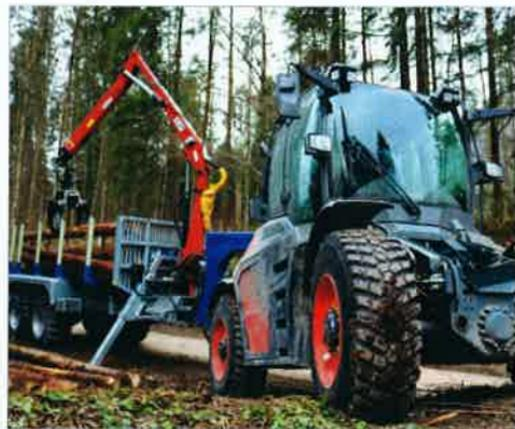
Ob Hacker, Schneefräse, Anhänger oder Kombinationsmähergerät – der **SYN TRAC** hat mit **420 PS** die Leistung, um Anbaugeräte optimal bedienen zu können und gleichzeitig mit bis zu 80 km/h die Geschwindigkeit, um schnell zwischen den Einsatzorten zu wechseln.
