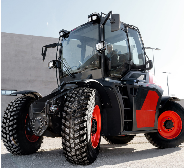
Der SYN TRAC verfügt über vollautomatisierte Docking-Systeme vorne und hinten, sowie über zwei gleichzeitig verwendbare Kuppelsysteme.
