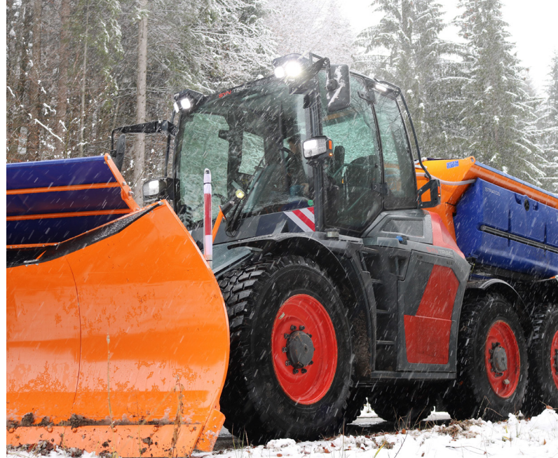
Der SYN TRAC verfügt über vollautomatisierte Docking-Systeme vorne und hinten, sowie über zwei gleichzeitig verwendbare Kuppelsysteme.
