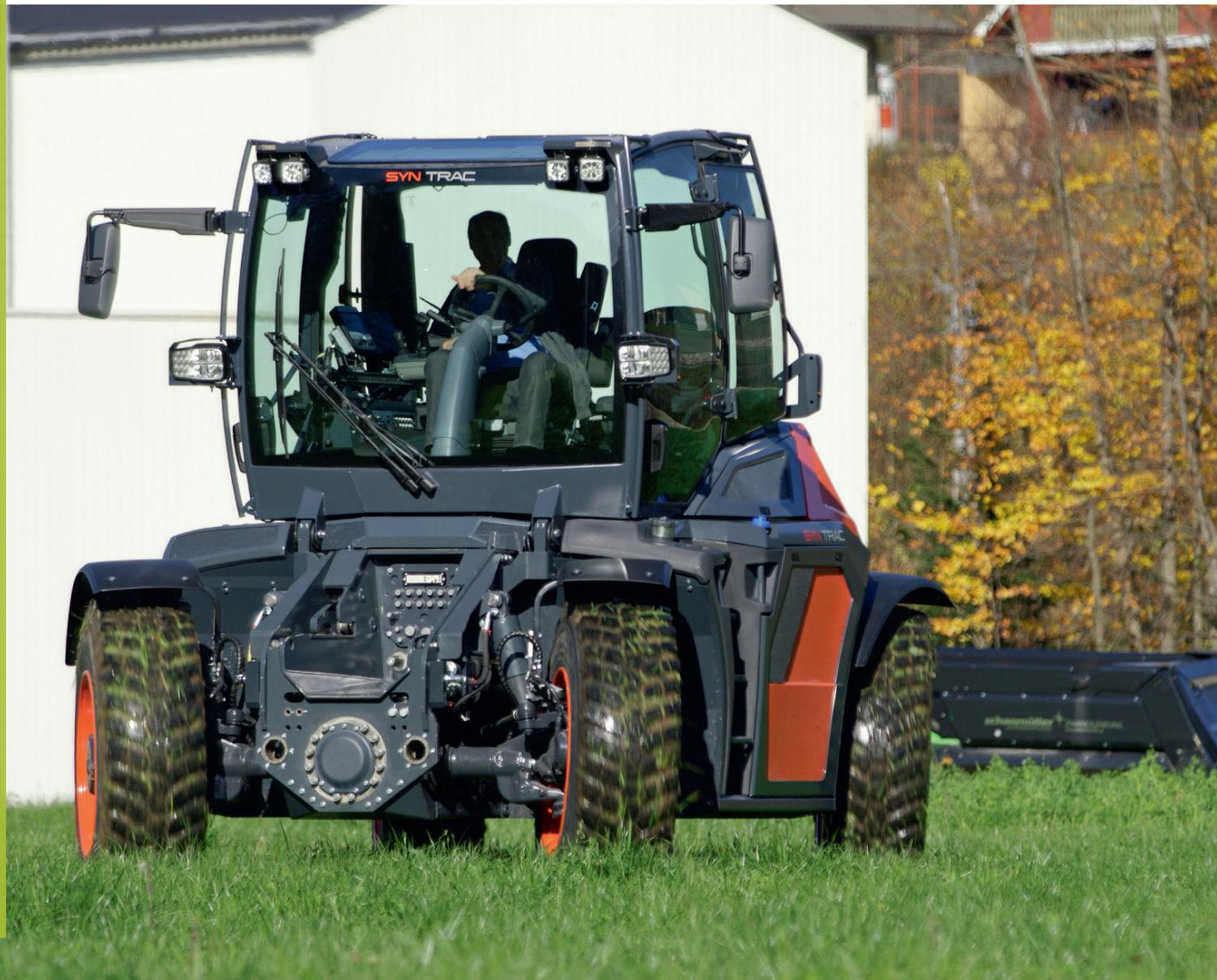
angetriebenen oder nicht angetriebenen dritten Achse unter einer Minute, ohne die Kabine zu verlassen. Aufgrund von vergleichsweise hohen Achslasten kann SYN TRAC auch schwere Anbaugeräte aufnehmen, ohne das Chassis zu verstärken oder Sondereinbauten durchzuführen. Zudem sind für das universelle Dockingsystem auch Normadapter mit Kommunalanbauplatte, Dreipunkthubwerk oder Anhängvorrichtung erhältlich.
