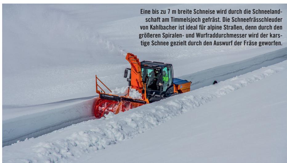
Eine bis zu 7 m breite Schneise wird durch die Schneelandschaft am Timmelsjoch gefräst. Die Schneefrässchleuder von Kahlbacher ist ideal für alpine Straßen, denn durch den größeren Spiralen- und Wurfraddurchmesser wird der karsichtige Schnee gezielt durch den Auswurf der Fräse geworfen.
