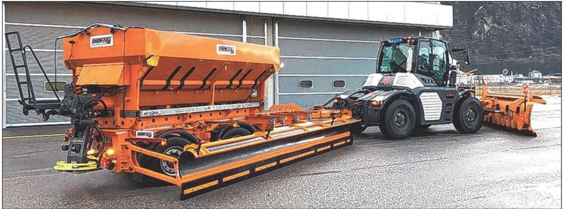
Die Kombination aus Fahrzeug und Anhänger (SYN TRAC und Snowkill) ergibt eine Räumbreite von knapp 12 Metern - die Autobahn wird somit in einem Arbeitsschritt befahrbar gemacht. Fotos: Siera
